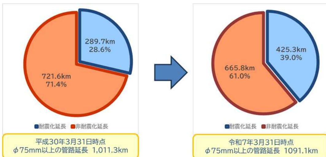
〔図 1-2〕 管路耐震化状況
